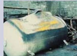
**Flüssiggastank mit Riss** durch Feueereinwirkung eines brennenden Campingwagens.
